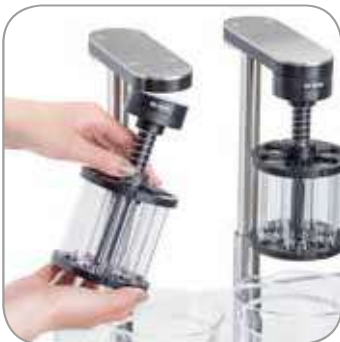
Très pratique: les paniers de contrôle sont magnétiquement couplés
