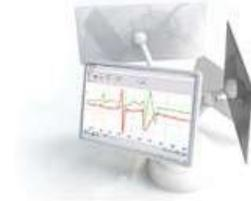
Le télémètre envoie en temps réel ses mesures sur le PC. Si une mesure n'est pas reçue par le PC, il l'enregistre dans sa mémoire interne et le renvoie lors de la communication suivante.
